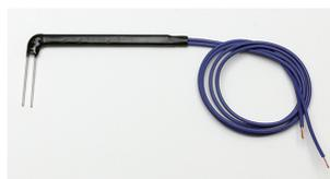
本体に付属の電極ホルダーに取り付けて使用します。電極部は白金。30cmのリード線付。
