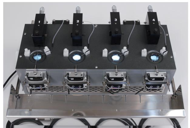
内部は恒温水槽からの温水を環流する水槽と、本体下側からの照明部分の2層になっています。
