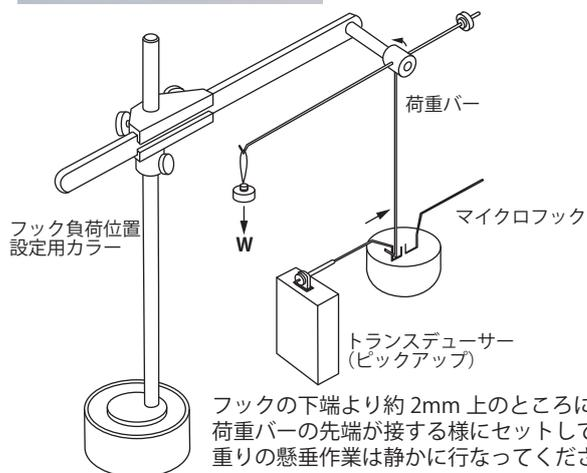
フックの下端より約2mm上のところに荷重バーの先端が接する様にセットして重りの懸垂作業は静かに行なってください。
