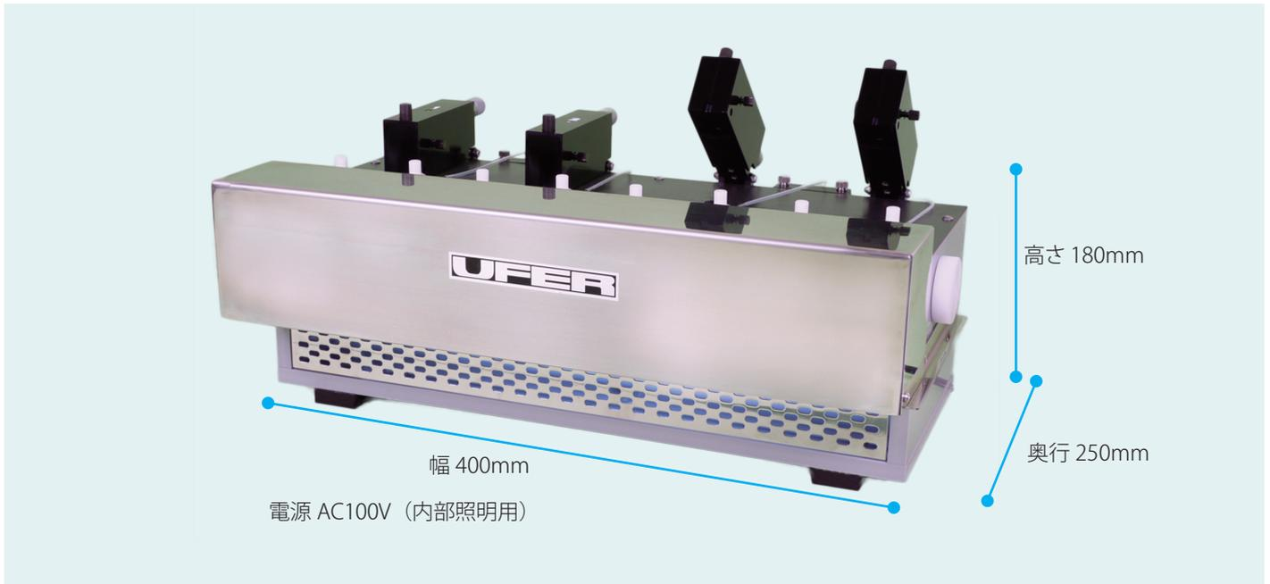
3次元マニプレーターは、標本支持フックの位置を前後・左右・上下に微調整が可能で、フック先端を合わせ易くセットアップがより簡単にできます。
