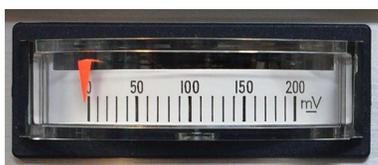
トランスデューサーに負荷をかけない状態で、OFFSET のボリュームをマイナスドライバーで回してメーターを 0mV に合わせます。
