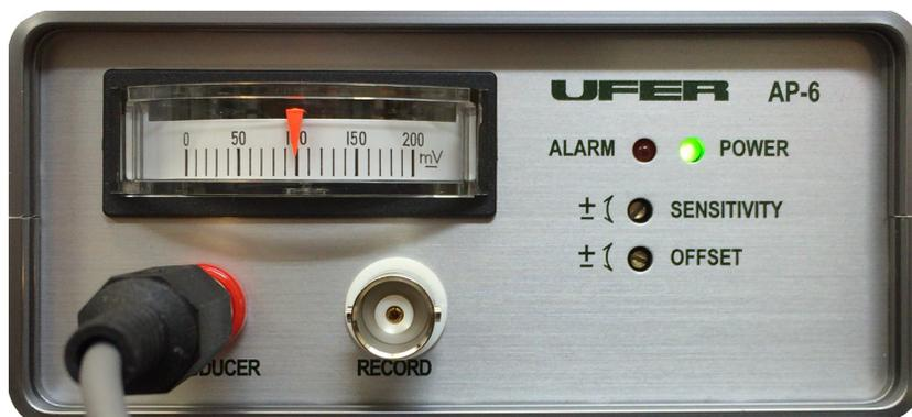
トランスデューサーを接続後、電源を入れて無負荷、負荷 1g、2g の時の出力を調整します。
