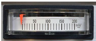
再びトランスデューサーに負荷をかけない状態で 0mV を示すかを確認し、もしもずれている場合は OFFSET のボリュームをマイナスドライバーで回してメーターを 0mV に合わせます。
